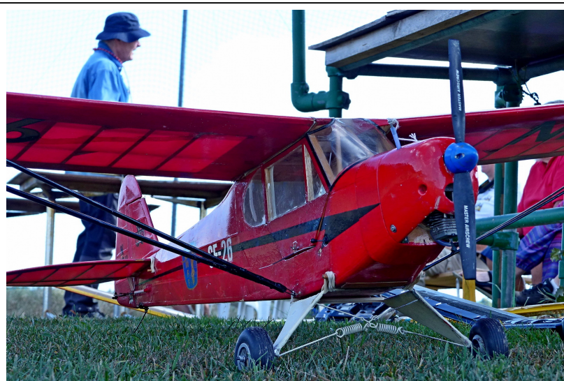
Här ser vi Johan Bagges fina Berkeley J3 CUB med en .30 4-taktsmotor. Modellen var den enda som tävlade med förbränningsmotor. Modellen konstruerades av Chuck Hollinger 1955 avsedd för en FOX .19
