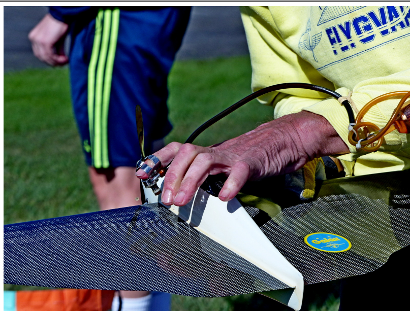
En trycksatt bränsleflaska på armen och en automatventil på fingret gör en tankning på under sekunden samtidigt som motorn startas och planet släpps. Planet fångas ofta i luften!
