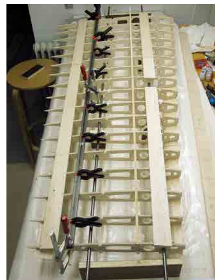
Två stålstänger ger rak vinge.
