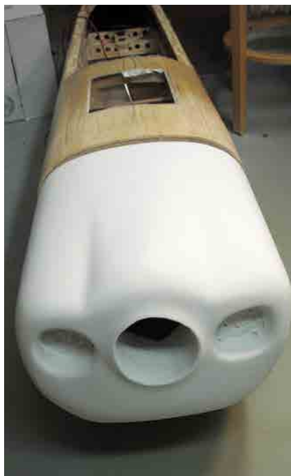
Plugg av cellplast för gjutning av form.
