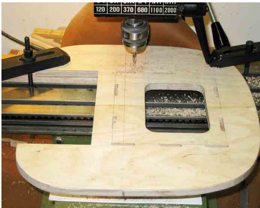
Fräsning av spår i brandvägg för motorkonsol.
