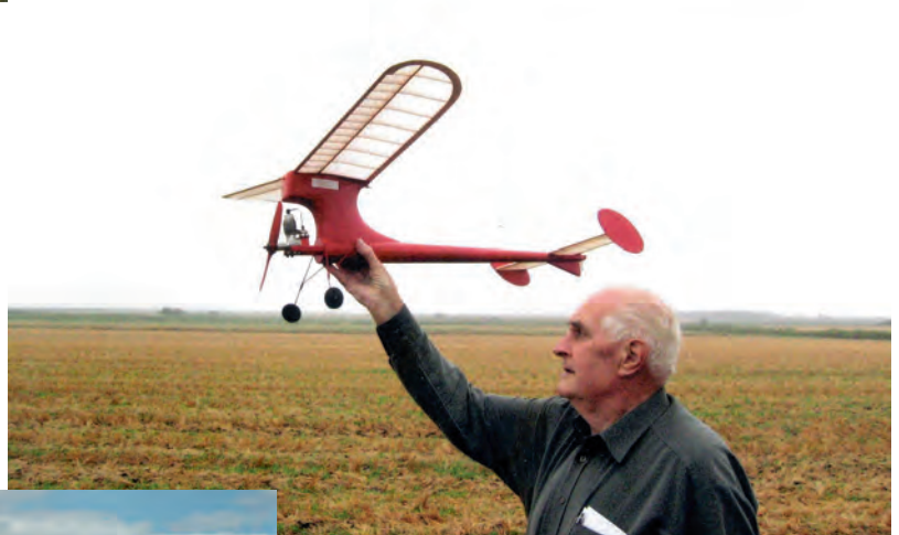
Denne flotte dieselmodel fra 1944 konstrueret af Tage Hansen var en af de første danske dieselmodeller. Tage anvendte en nykonstrueret dansk Monsun-motor. Poul præsenterede sin model ved DM 1998 på Skjern enge. Han anvendte dog den nyere danske Viking-motor fra 1950. Monsun-motorer er sjældne nu om dage...
