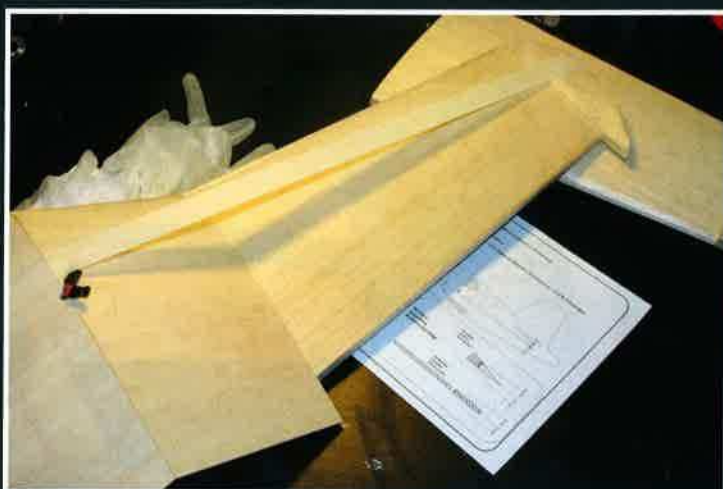
En vingspets under fastlimning, det gäller att få vinklarna rätt.
