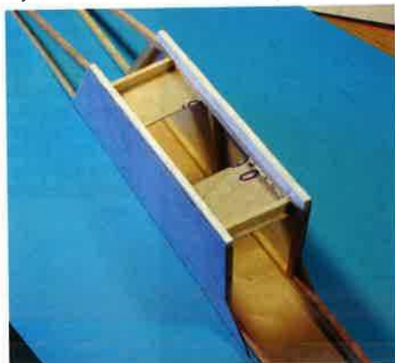
Plywoodförstärkningar på tvären.
