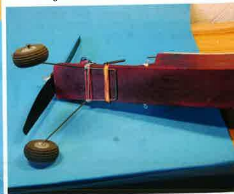
Det enkla är oftast det smartaste. Stället sätts fast med små gummiband
