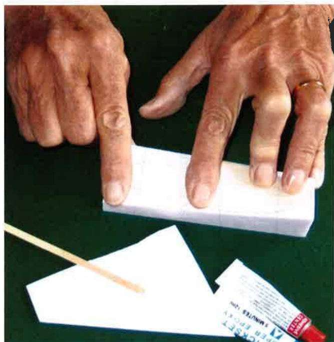
Nu är det tålamod som gäller. Håll fast mellanlägget i fem minuter, minst!
