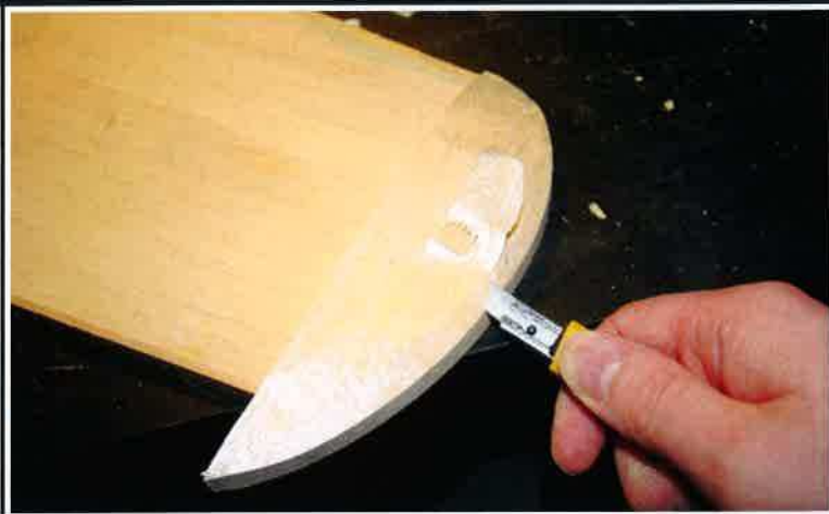
Jag använde en kniv för att grovforma vingspetsarna
