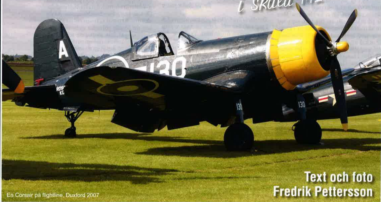
Hjulen roterar 90 grader vid infällning
