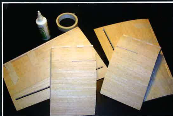
De fyra bitarna som utgör vingen vid limning av framkanten
