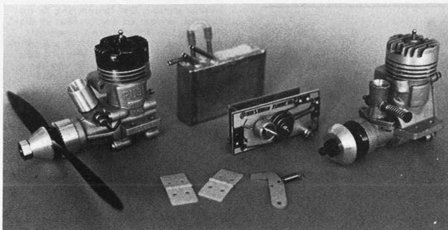
POWER TO THE PEOPLE. Detaljer enligt text. Fr.v. Fuji 15, tank, timer och Fox 15. Framför gångjärn och stabbkrok. Foto: Lars-G.
