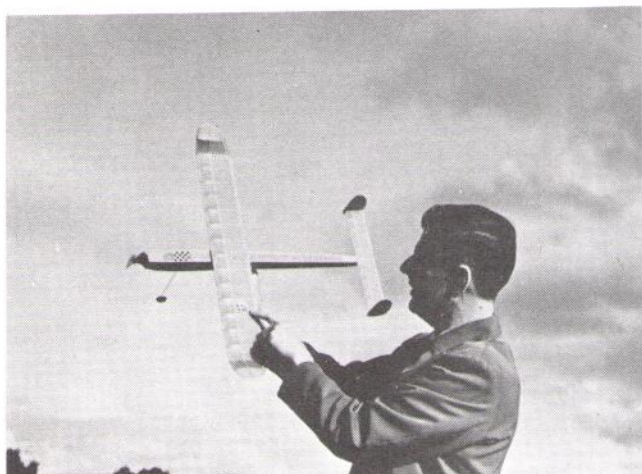
Meteor heter denna modell och är från 1947, varför den inte kan anses som en äkta oldtimer. OBS Enbent landningsställ men dubbelfenor ger tre kontaktpunkter för markstart. S O Lindén visar SMFF-dekalen.
