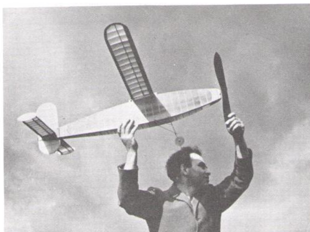
Lennart Skoog, Nimbus, hann se att hans Ellilä-konstruktion verkligen kunde flyga innan den totalkvaddades. OBS De två gummimotorerna. Två kugghjul i aktern överför kraften från den undre gummimotorn till den övre.
