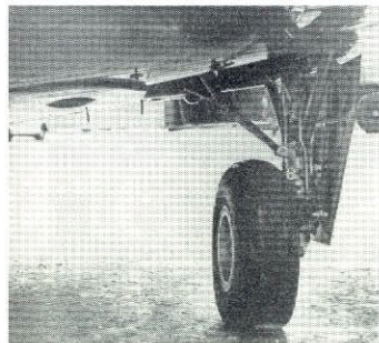
Landställslucken är stängd även då stället är ute och förhindrar därigenom att smuts tränger in vid markkörning.
