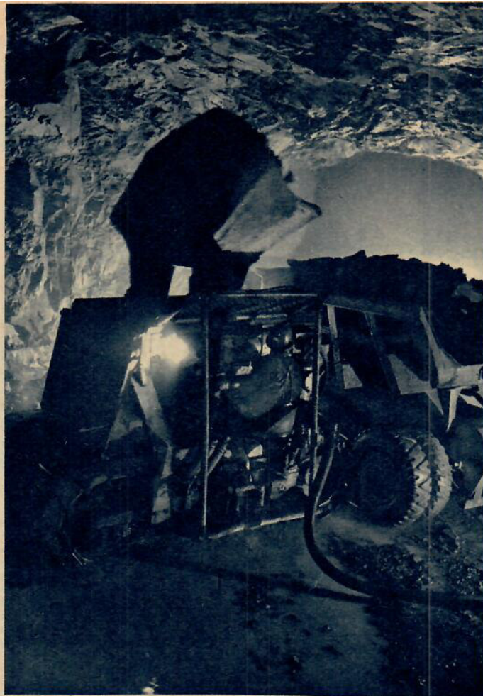
Jätten i Kiruna, LM 600, är världens största luftdrivna lastkastare. Kapaciteten är verkligen enorm. Den lastar nedan på transportband.
