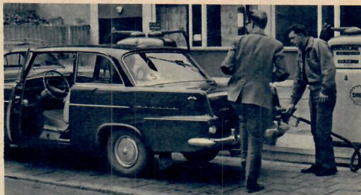
I stället för att använda mer eller mindre komplicerade instrument för mätning av förbrukning kan »fulltanksmetoden» rekommenderas. Tänk bara på att tillförlitligheten står i proportion till den körda sträckan.
