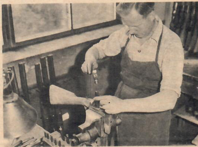
Höpsättaren av gevär kallar ekipör. Här slår »Jycken» Johannesson sitt »bomärke» i en hammerlessbaskyl. Ett prydligt J för Johannesson blir det.
