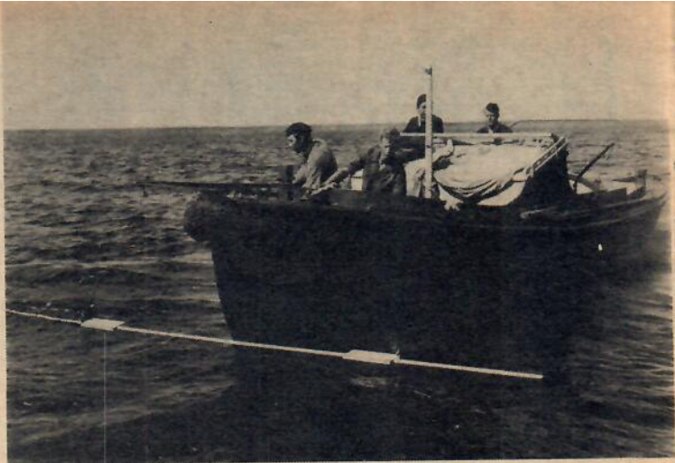
Här har ett s. k. stångsvep riggats upp. Det bogseras sedan sakta under båten och i linorna känner man när det tar i botten. Det används för att finna en klacks minsta djup. Teppens läge bestäms så med vinkling.
