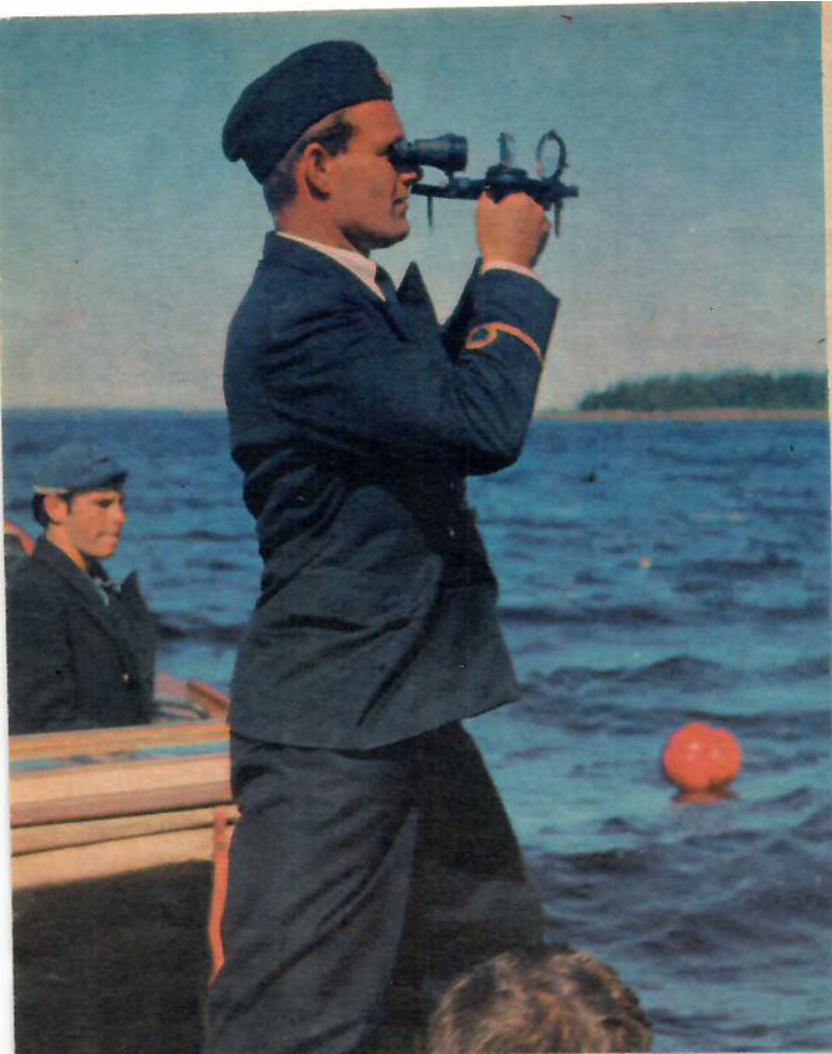
Kustsjömätarnas små båtar navigerar inte med decca. Där får man i stället bestämma läget optiskt med s. k. vinkling, en metod som man får rika tillfällen att öva. Hundratals vinklingar per dag är inte ovanligt.
