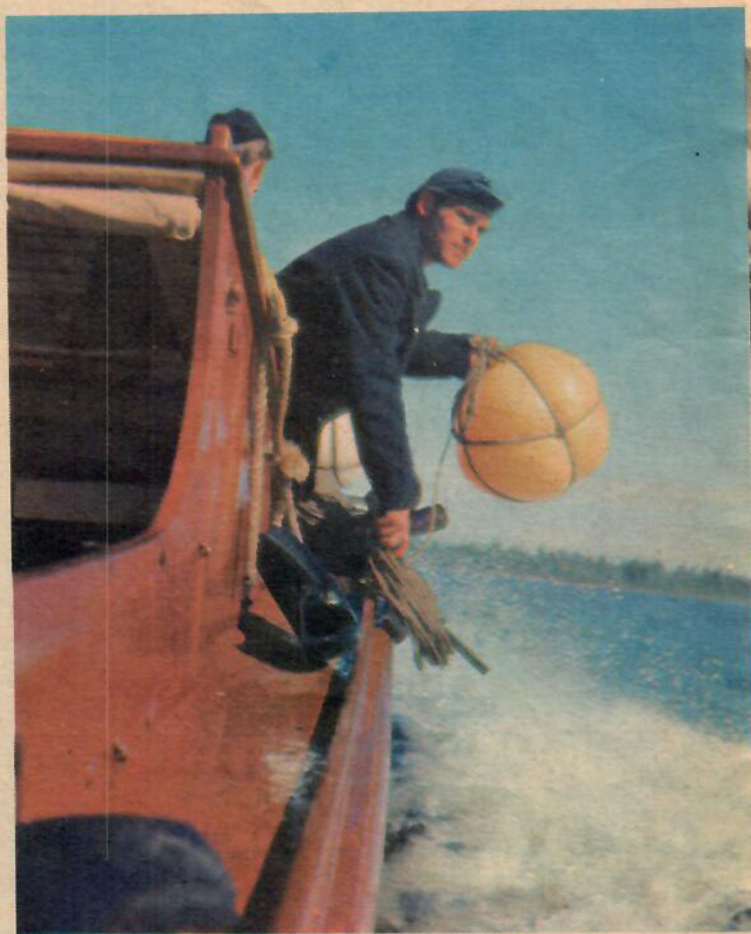
Kustsjömätningen sker i rutor 200×500 m. Innan själva mätningen börjar markeras hörnen med plastbojar, s. k. vålar, vars läge bestäms med vinkling. Övriga vålar läggs ut i full fart med jämna avstånd efter klocka.
