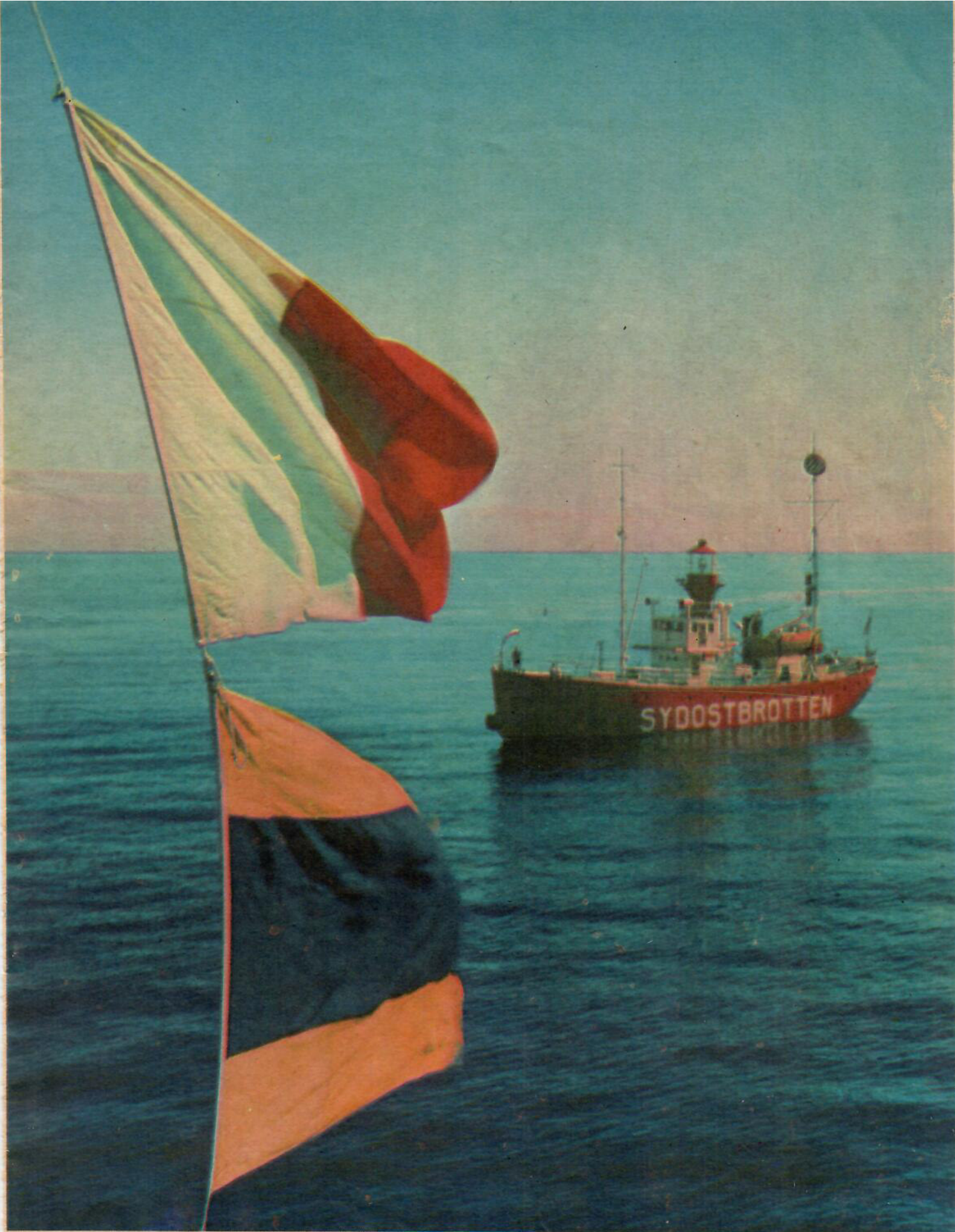
Med sydostbrottens röda fyrskepp som effektiv bakgrund hissas signalflaggarna »H» och »D» på Gustaf af Klint. Den internationella signalen betyder, »Håll undan för mig, jag utför sjömätning».
