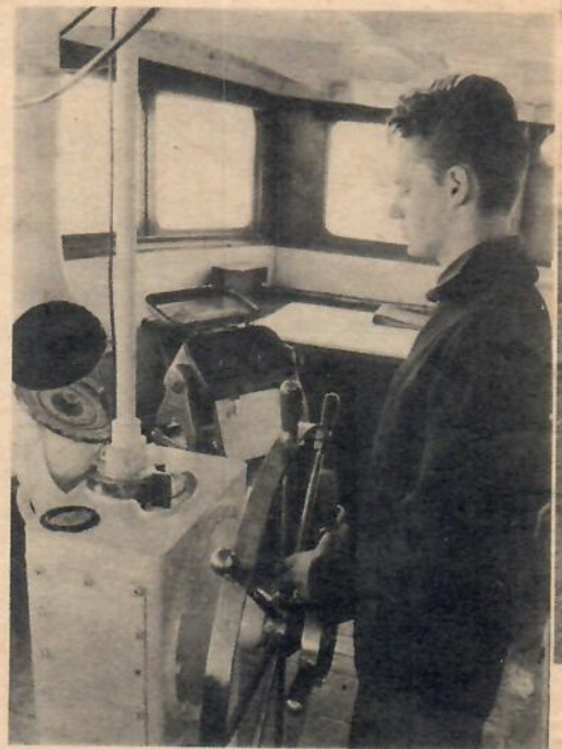
Decometerns två visare i bildens mitt håller fartyget på exakta, snörräta kurser i alla väder.
