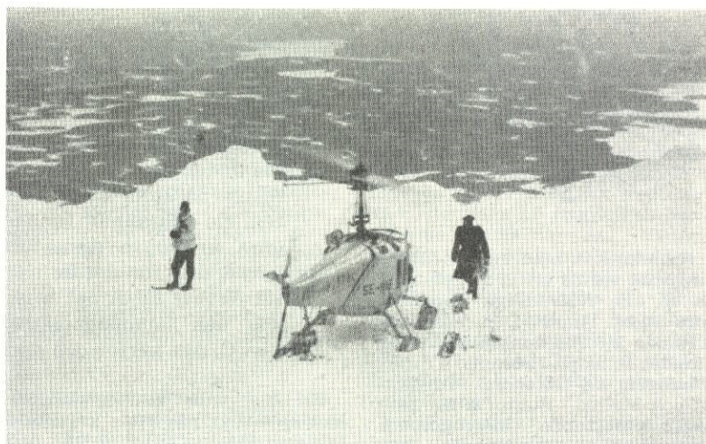
Åreskutan är besegrad. Nils-Gunnar Grimskog har landat på skutans topp bland drivor och skavler. Lägga märke till metallskidorna som utexperimenterats av Ostermans ingenjör Wallert och som är utomordentligt nyttiga på snö. De bär maskinen även i lös nysnö.
