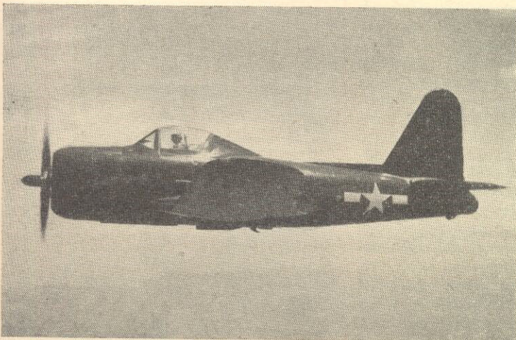
Nedan: En profil med karaktär i dragen! Lägga märke till att man lagt särskild vikt vid att föraren får god sikt. Han kan se framför vingkanten. — Nedan till höger: Så här ter sig "Fireball" med vingarna uppfällda. Som synes är landstället av trehjulstyp.
