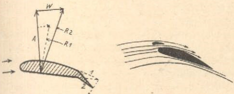
Bild 7: Schematisk skiss över hjälpvinge (slot) till höger och klaff (till vänster).
