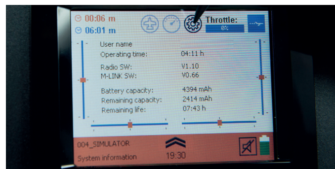
Informationsskärmen visar total användningstid för sändaren, mjukvara och batteristatus. Som ni ser så står det 4394mAh på batteriets kapacitet och det sitter bara ett 4000mAh i sändaren. Multiplex säger att sändaren programmeras på 4400mAh i fabriken och efter några timmars användning kommer detta värde att justera sig till ett riktigt värde som elektroniken räknar ut.
