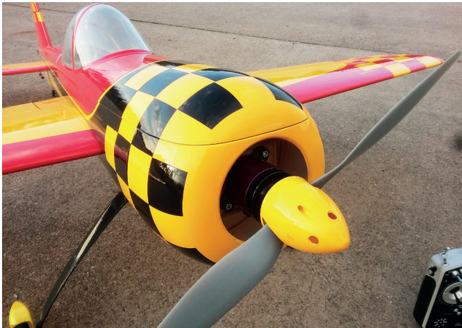
Outrunnern under en provflygning, batteri och motor bli betydligt varma
