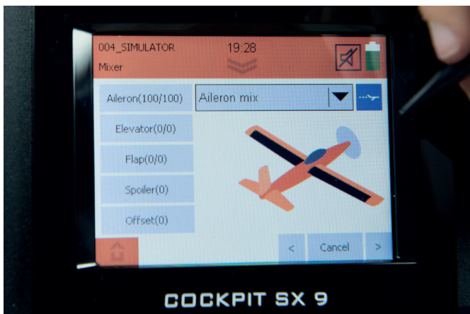
Servokonfigurationen kan justeras på olika sätt, det enklaste är faktiskt att med pekpenan eller med ett finger flytta punkterna på skärmen och sedan eventuellt finjusteras med "+" och "-" tecknet på skärmen.
