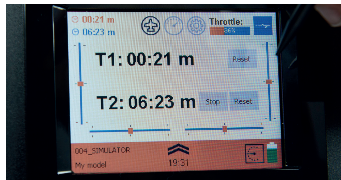
När man startar sändaren hamnar man i ett fönster med två timers, en för flygtid och den andra är en total tid. I mitten ser man vilken skärmmeny man är på, med en enkel finger från höger till vänster över skärmen förflyttar man sig till telemetriskärmen och sedan till informationsskärmen. Högst upp till höger visar den blå vita ikonen vilken flygfas man är i. Längst ner till höger är batterinivån i sändaren med symbolen för vad "speakern" skall säga, i detta fall är bara altimetern aktiverad, man kan med talande telemetri aktiverad har sändaren lite över 400 ord i sitt minne. Med dubbelpilen ovan klockan!
