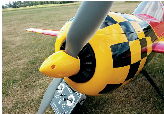
3D printat kylflöjstäck får gott om plats med den långsmala C50XL i nosen
